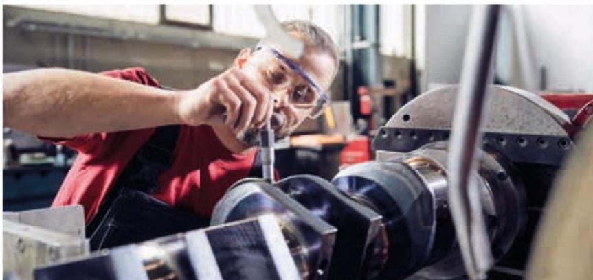
En fonction des prescriptions des fabricants, il est possible, dans le cadre d'une révision générale, de réutiliser des composants de moteurs. Nos techniciens d'atelier démontent le moteur, nettoient tous les composants, vérifient qu'ils ne sont pas endommagés et mesurent l'usure selon les spécifications du fabricant. Si les pièces ne sont pas endommagées, qu'elles sont toujours dans les
